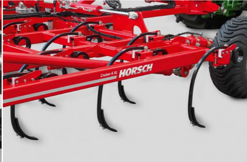
HORSCH Federzinken (150 kg Auslösekraft)
