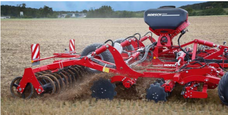
Joker RT mit optionaler MiniDrill: Saatgutverteilung vor dem Packer mit Prallteller
