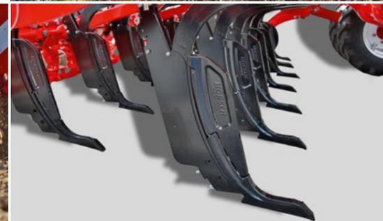
**ULD+ Schare** lockern den Boden tief und fördern auch im schweren Boden keine groben Kluten nach oben.
