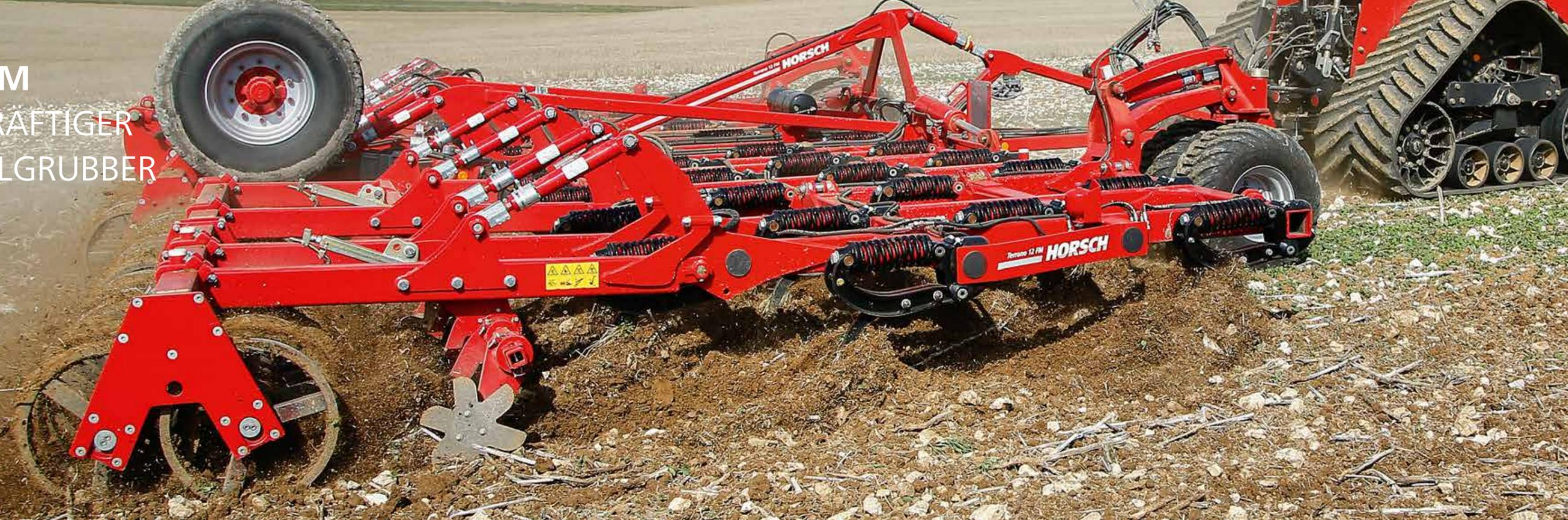
Der **Terrano FM** eignet sich von der flachen Stoppelbearbeitung bis zur mitteltiefen Bodenbearbeitung, je nach Schlepperleistung. Er erreicht eine intensive Mischung durch seinen 4-balkigen Aufbau und bleibt bei einem Strichabstand von 27 cm trotzdem leichtzügig.
