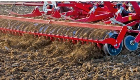
**SteelDisc Packer** zur optimalen Rückverfestigung auch auf schweren Böden
