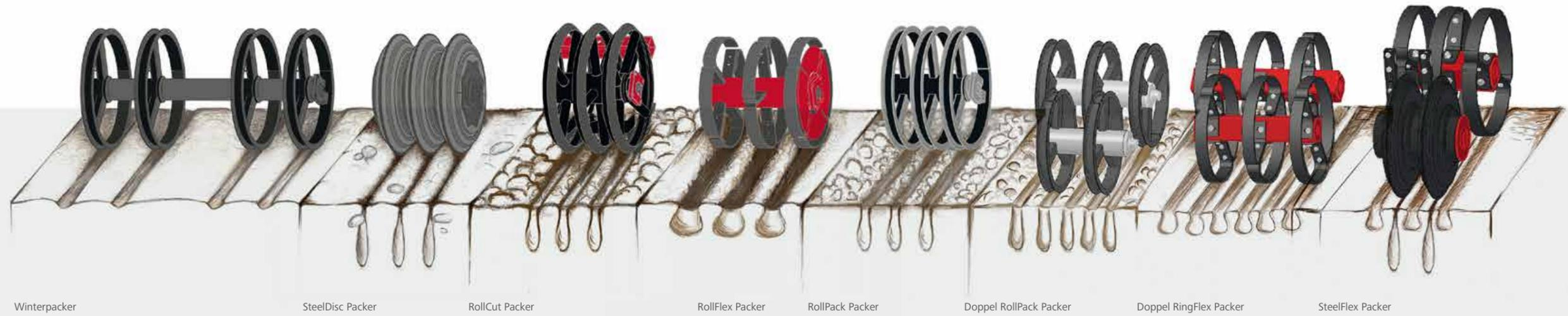
HORSCH bietet sowohl für die tiefe als auch für eine flache Rückverfestigung die richtige Packervariante. Die Packerwahl ist immer bodenabhängig, dabei bietet HORSCH für jeden Bodentyp eine sinnvolle Lösung. Durch Rückverfestigung wird übermäßig lockerer Boden verdichtet, Kluten zertrümmert und ein optimales Umfeld mit einem optimalen Verhältnis von wasser- und luftführenden Poren geschaffen.
