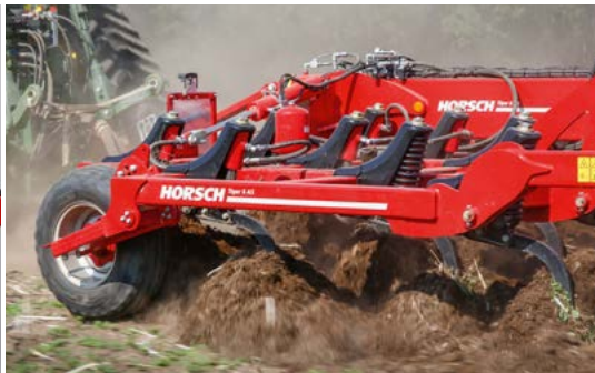
Hydraulische Sicherung des TerraGrip Zinkens für Auslösekräfte von bis zu 770 kg (optional für erste und zweite Zinkenreihe für Tiger 5, 6, 8 AS)
