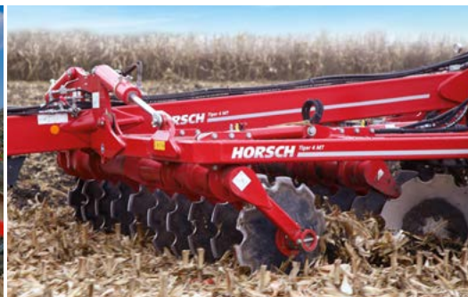
Zweireihiges DiscSystem Schneidet alle Ernterückstände durch
