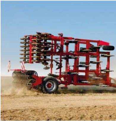
Schwenkfahrwerk in Transportstellung
