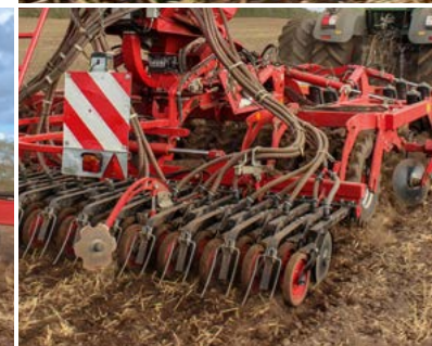
TurboDisc Scharschiene 15 cm Reihenabstand, integrierte Schar- dämpfung, stufenlose Schar- druckverstellung bis 120 kg/Schar
