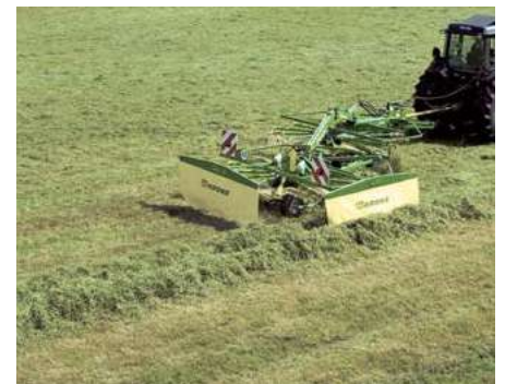
Dubbel zwadafleg Een dubbel zwad van 12,4 m
