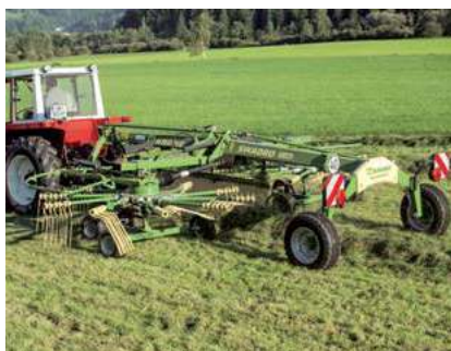
Swadro TC 640 en Swadro TC 680 Werkbreedte: 5,70 m – 6,40 m en 6,80 m
