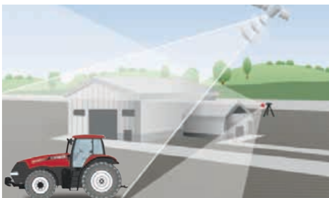
xFill overbrugt hiaten tot 20 minuten in RTK-signalen.
