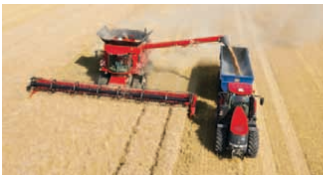
AFS Accuguide: Geleiding via GPS en GLONASS voor haarfijne precisie, onafhankelijk van de gewasomstandigheden. Nauwkeurigheid tot op 2,5 cm mogelijk.
