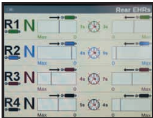
Bedien uw afstandsventielen via het AFS 700 Pro-scherm.
