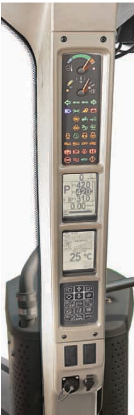
Alle informatie over de tractorprestaties in één oogopslag.
