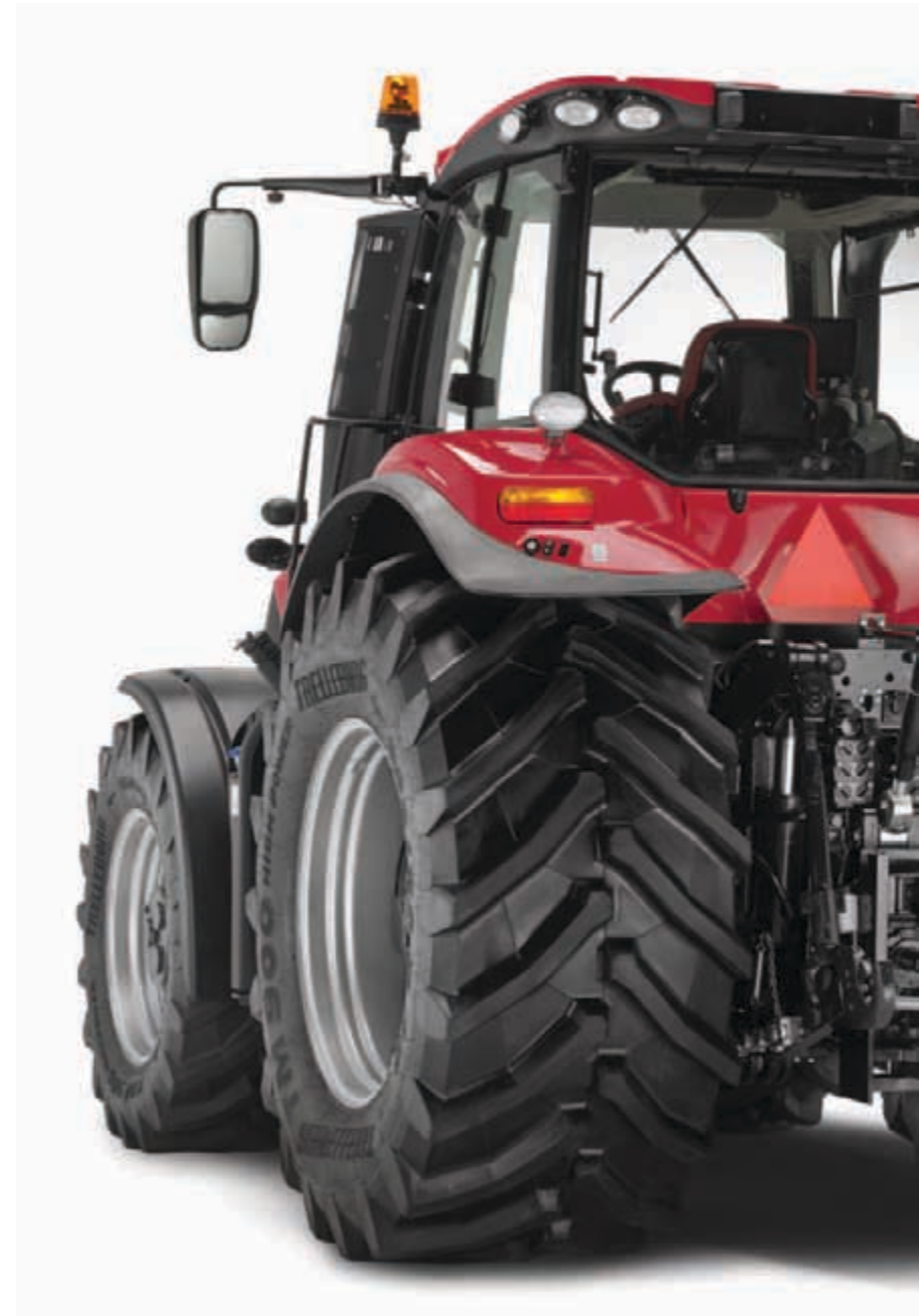
Geen bedieningsgrenzen dankzij 6 elektrohydraulische afstandsventielen achteraan.
