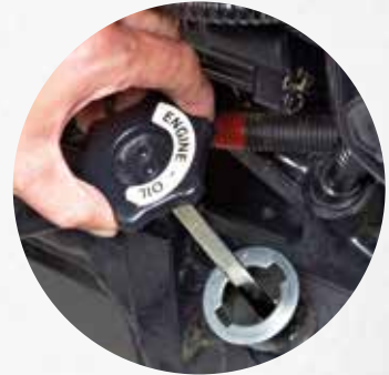
Controle van oliepeil en bijvullen zonder de motorkap op te tillen.
