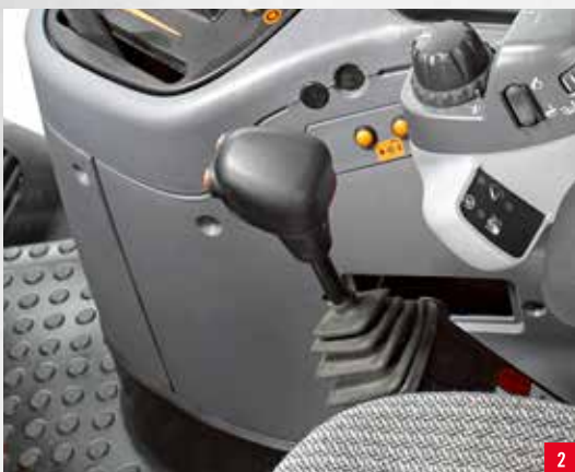
1 Joystick voor werkzaamheden met de voorlader bij de Profi en Profi CVT
