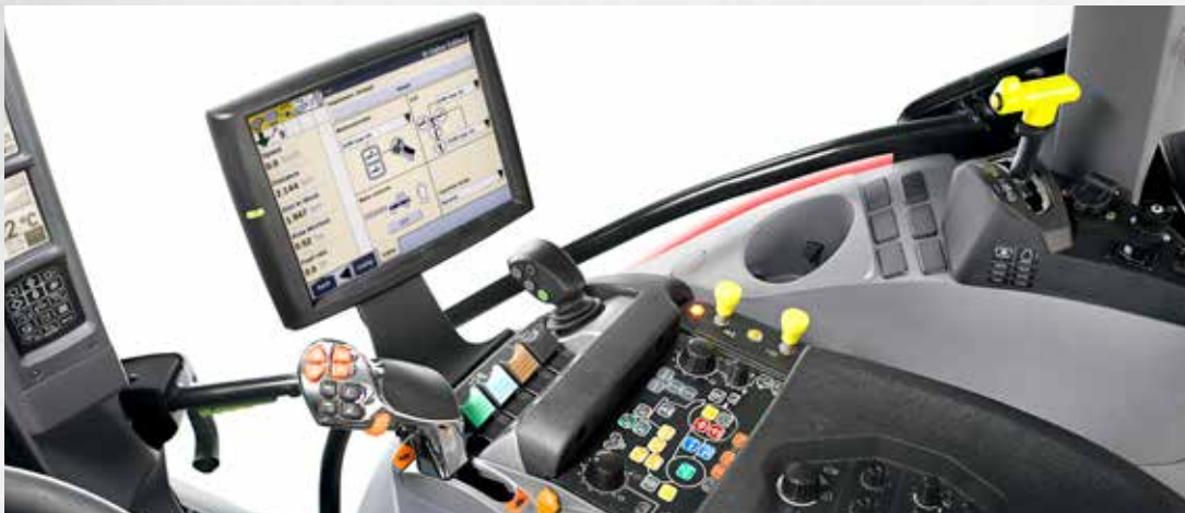
De Profi en Profi CVT zijn met max. 4 elektrische regelventielen uitgerust.
