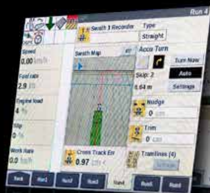
S-Turn keert automatisch aan het eind van het spoor
