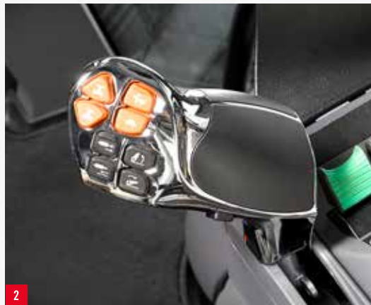
1 Classic transmissie schakelhendel op de Profi Classic, 2 en de Multicontroller hendel op de Profi
