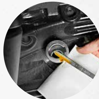
Controle van oliepeil en bijvullen zonder de motorkap op te tillen.
