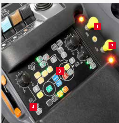
Bediening aftakas bij Profi en Profi CVT.
