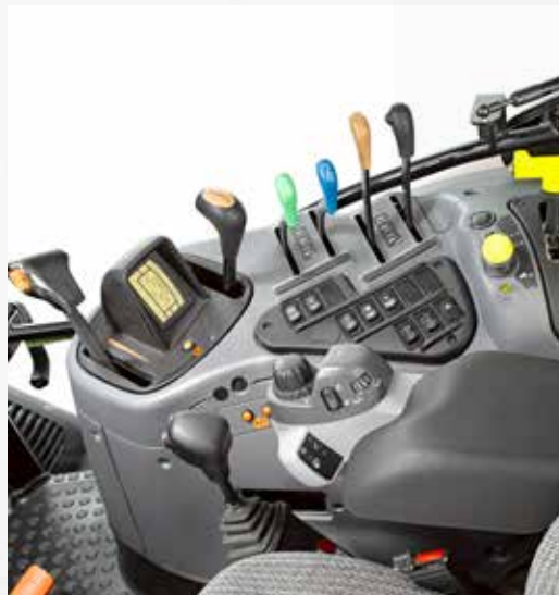
De Profi Classic is uitgerust met mechanische regelventielen en een elektrische regeling voor de hefinrichting (EHR).
