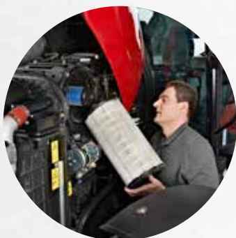
Continue reiniging via een piclon-filter zorgt ervoor dat het filter alleen hoeft te worden onderhouden wanneer het betreffende waarschuwingslampje aan gaat.
